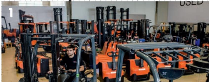
**Inspection:** lorsqu'un nouveau chariot d'occasion arrive chez Toyota, l'inspection permet de déterminer sa classification et son éligibilité à la réparation et à la vente. Sa batterie est mise en charge afin d'en tester l'état et la capacité.
