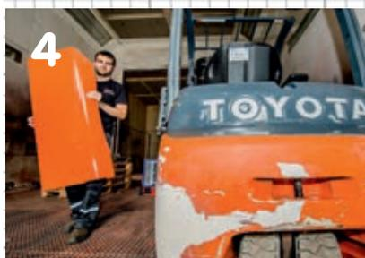
**Peinture:** après le nettoyage et les tests, le chariot passe dans l'atelier peinture: il est soumis à un rafraîchissement ou repeint dans sa totalité selon les besoins. Au final, il est aussi beau qu'un chariot neuf!
