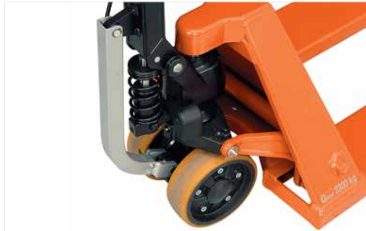
De stuurarm van de BT Pro Lifter maakt gebruik van een hefboomwerking op de wielen om de wagen in beweging te krijgen
